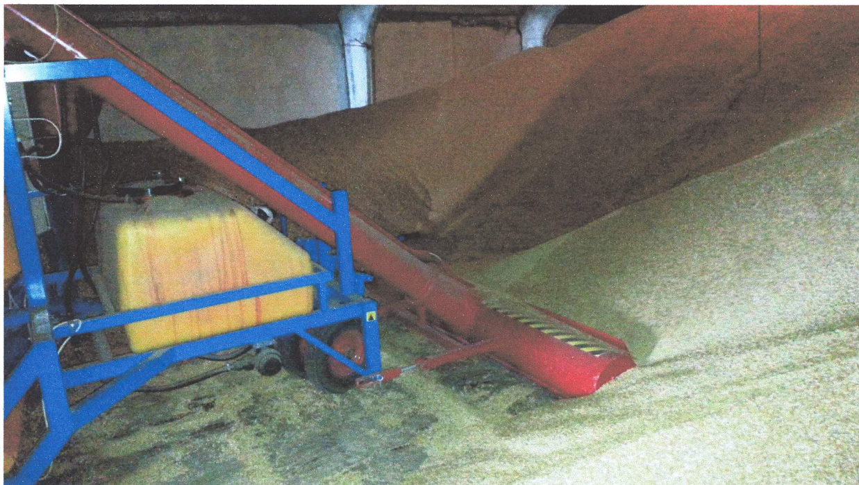
Фото №1. Проведение предпосевной обработки семян с помощью автоматического протравливателя ПСК-15
